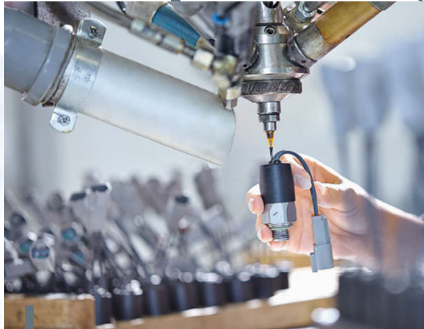
Équipement d'encapsulation de pressostats précâblés personnalisés requérant un IP élevé.
