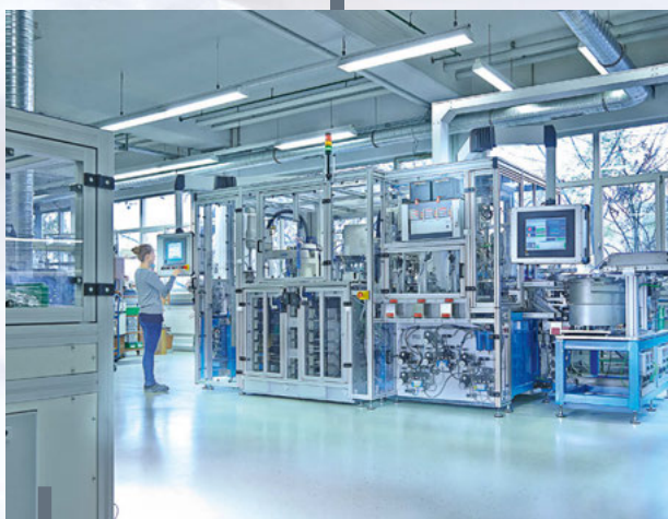
Installations semi et entièrement automatisées pour montage et tests des pressostats.
