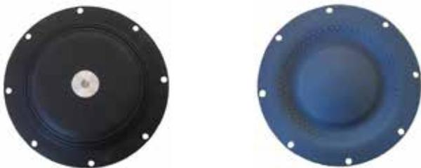
Die TU-Membran hat nur luftseitig einen Stabanschluss und eine leicht zu reinigende Flüssigkeitsoberfläche. Das bedeutet, dass sich hinter Schrauben, Mittelscheiben usw. keine Farb- oder Lackreste ansammeln können, was eine Farbverschmutzung verhindert.
