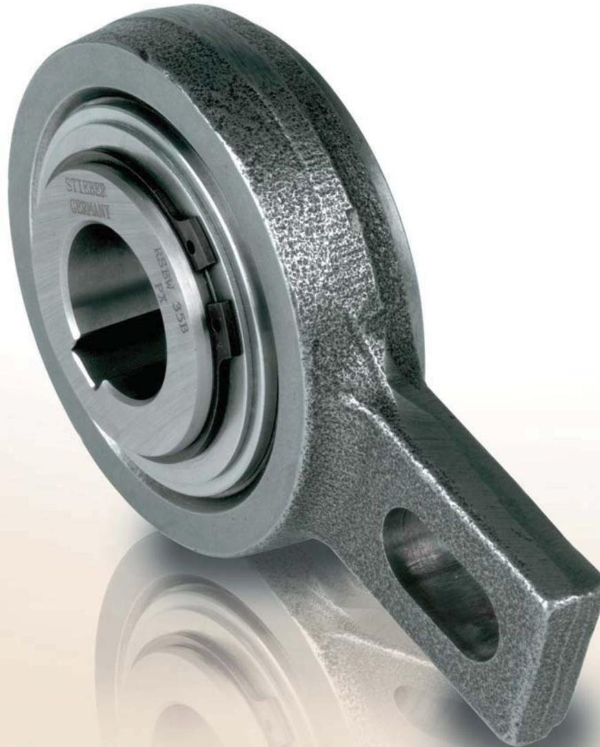
Die Bauart RSBW ist ein Klemmkörperfreilauf. Er ist gleitgelagert und für niedrige Drehzahlen geeignet. Das Drehmoment ist bei geringem Bauraum sehr hoch. Der Freilauf wird mit Fettschmierung geliefert; die Abdichtung erfolgt mit O-Ringen.
