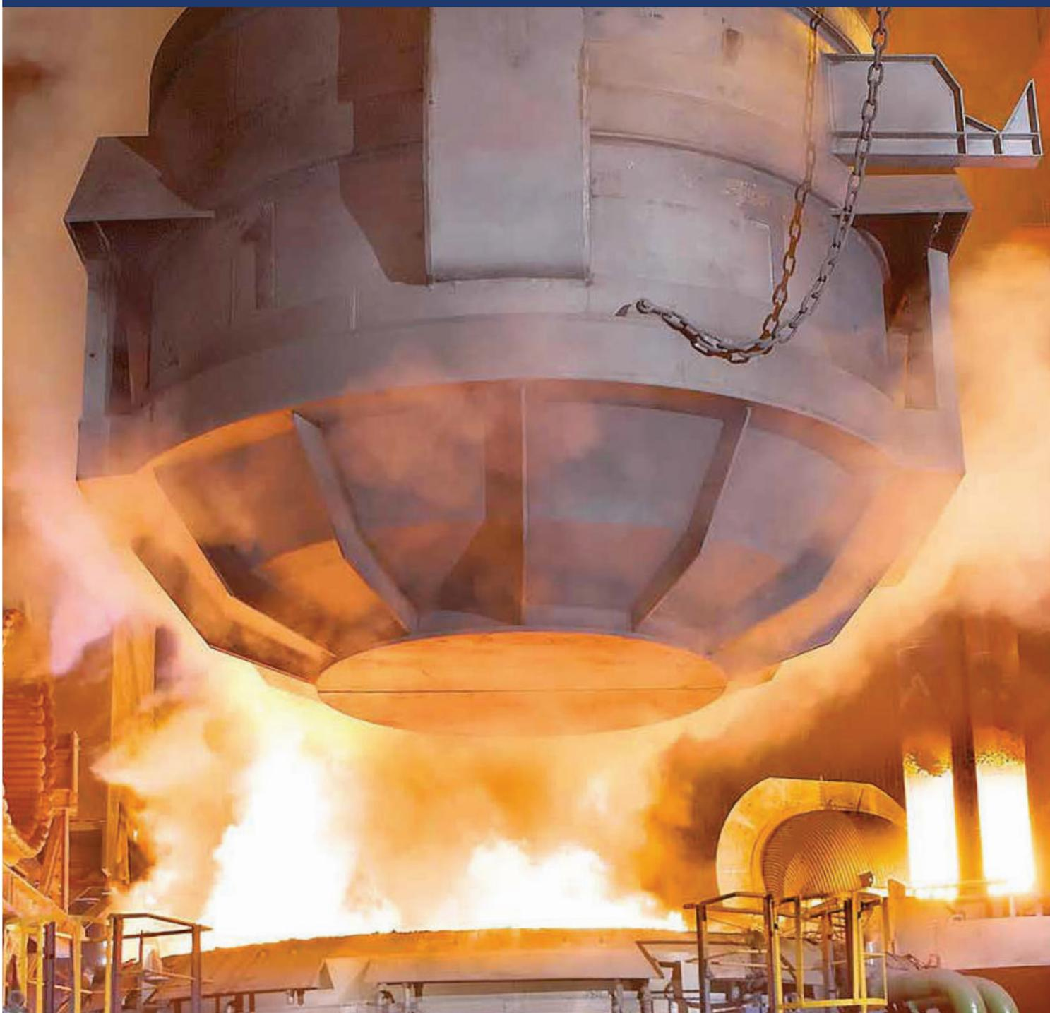
Bei diesem Ofen ist es erforderlich, dass große Schrottteile aus großen Höhen herunterfallen. Mittels einer Vielzahl von Zugeinrichtungen bis zu 80.000 Joule/Stück werden diese Teile oberhalb der Schmelze aufgefangen. Hohe thermische Belastungen müssen dauerhaft ertragen werden.
