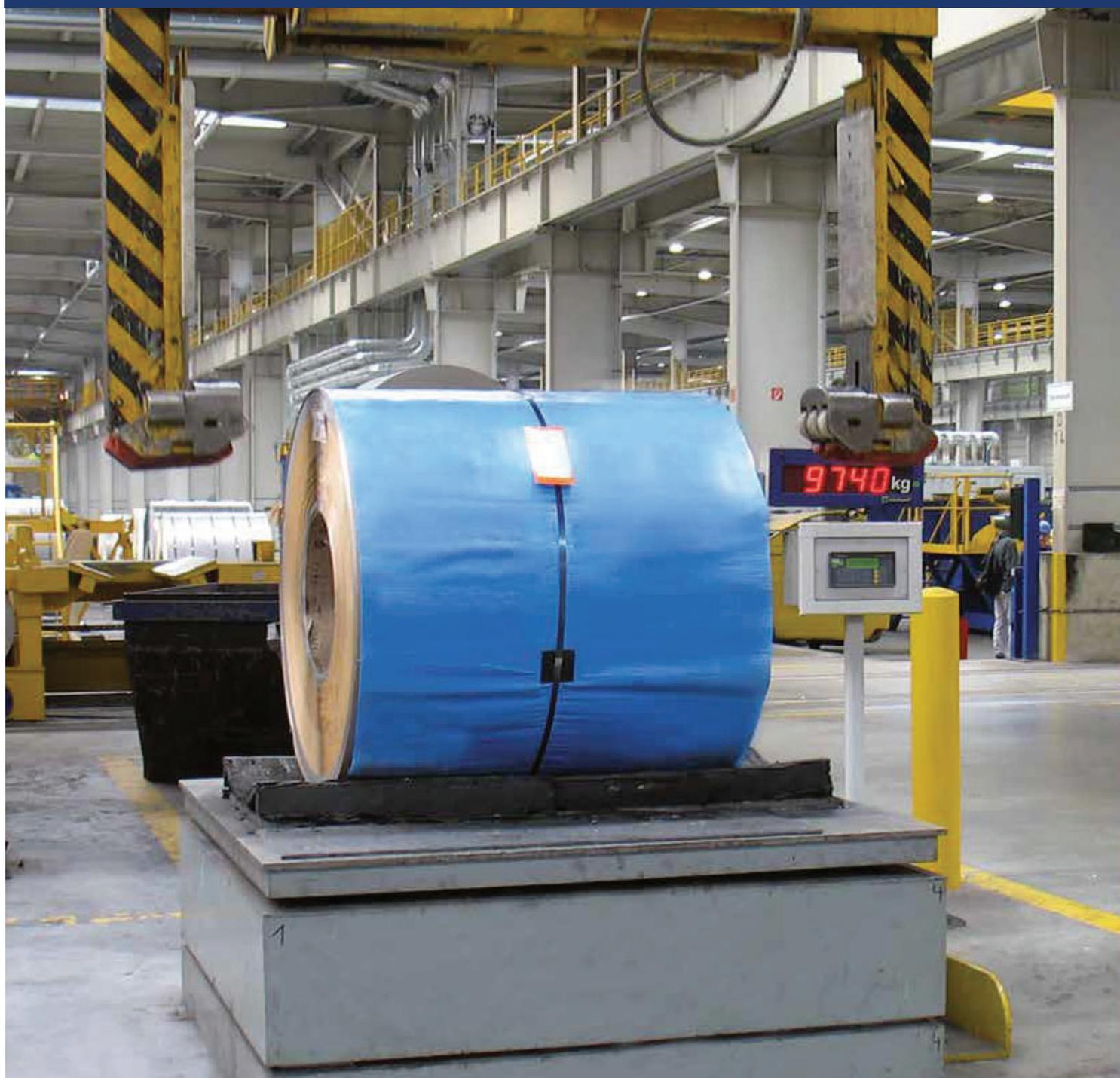
Auch bei noch so kleinen Absetzgeschwindigkeiten entstehen Stöße welche bei sensiblen Maschinenteilen wie hier bei den Wägezellen, zu Beschädigungen führen können.
