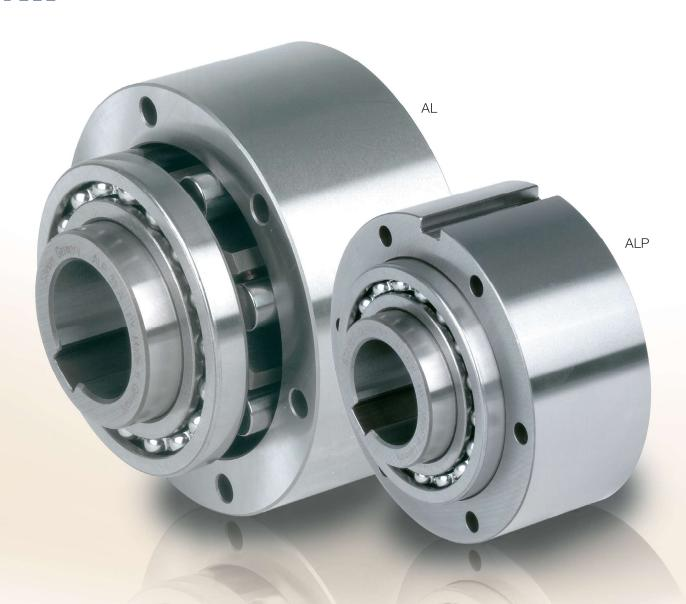
Les modèles AL, ALP sont des roues libres à rouleaux. Ce sont des modules de base autocentrés par deux roulements série 160.. En standard, une lubrification à l'huile est à prévoir.
