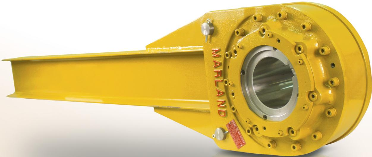
Die Bauart BC MA ist ein abgedichteter, montagefertiger Rollenfreilauf, der gelagert ist. Standardmäßig muss eine Ölschmierung vorgesehen werden. Diese Rücklaufsperrung wird überwiegend an der Antriebsstrommelwelle von großen Schrägförderbändern eingesetzt.
