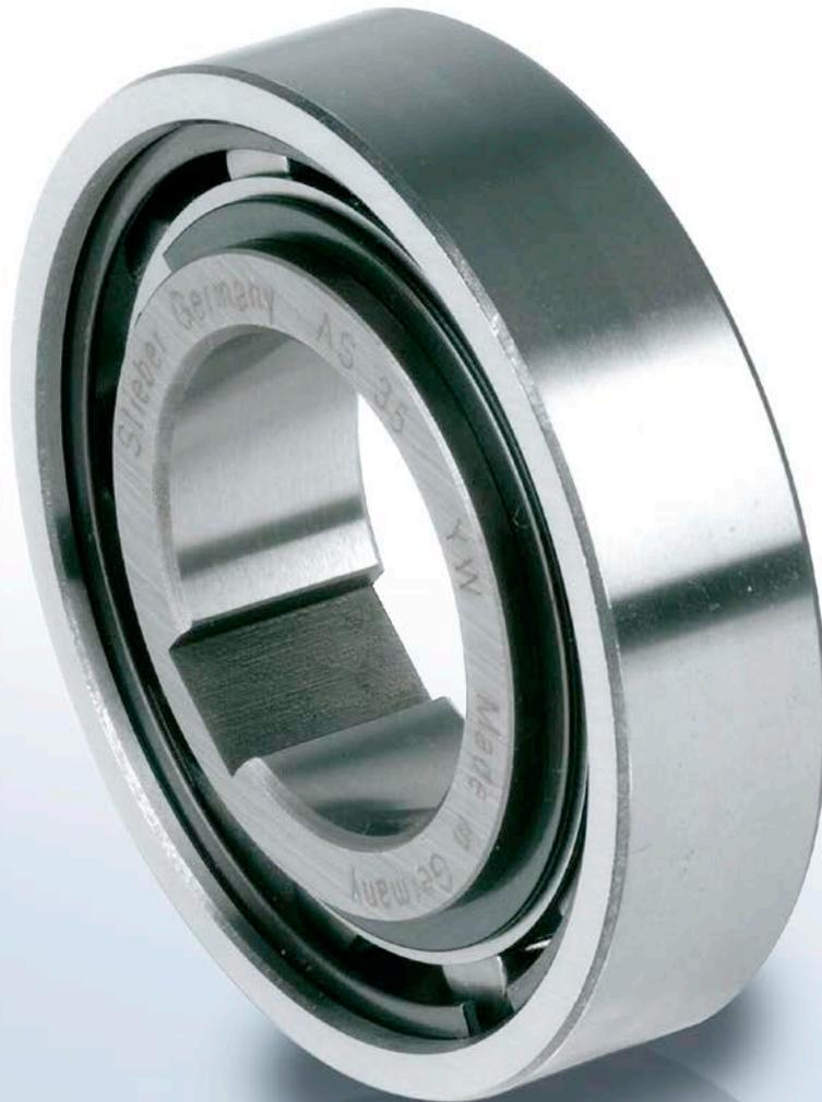
Die Bauart AS ist ein ungelagerter Rollenfreilauf. Auf eine einwandfreie Lagerung, Schmierung und Abdichtung des Freilaufes ist zu achten. Die Einbaumaße entsprechen der Kugellagerreihe 62..
