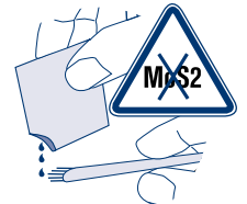
Nabe und Welle gegebenenfalls leicht einölen (keine MoS2-haltigen Öle verwenden).
