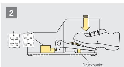
Bei leichtem Druck (~19 N) auf den Pedalbetätiger schaltet eine der beiden Kontakteinheiten um, während die andere ihren Zustand beibehält. Der Pedalbetätiger verbleibt am Druckpunkt.
