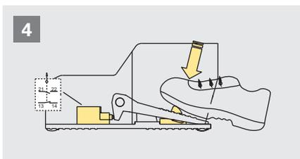
Um den Betätiger des Pedals zu entriegeln, muss auf die Verriegelungsvorrichtung gedrückt werden.
