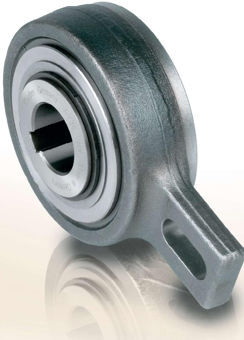
Le modèle AV est une roue libre à rouleaux. C'est une version autonome; centrée par paliers lisses pour des vitesses de rotation faibles. Des joints labyrinthe métalliques assurent l'étanchéité.
