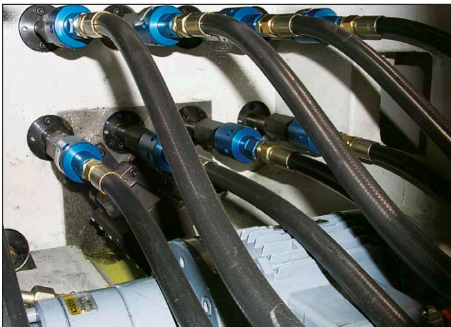
Deublin 1116 Drehdurchführung mit eigener Lagerung an Transferstraße
