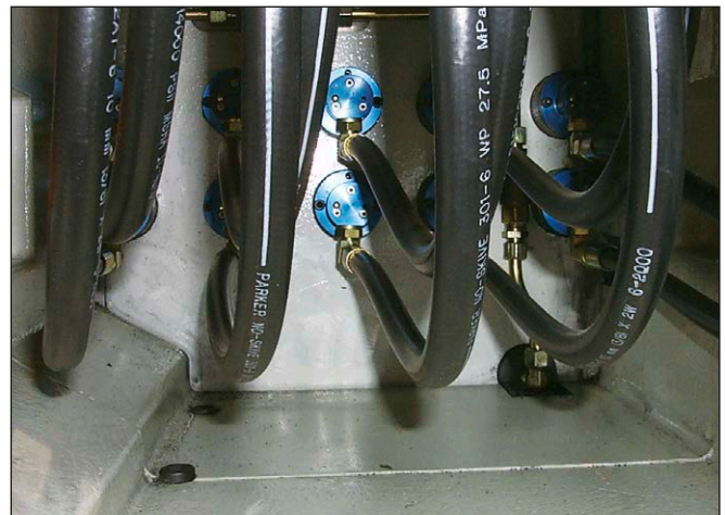
Deublin 1117 lagerlose Drehdurchführung an Transferstraße
