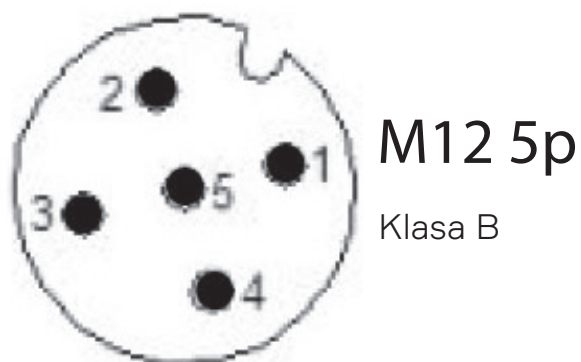
Figure 8 Konfiguracja wtyków w wersji IO-Link i z odrębnymi domenami zasilania
