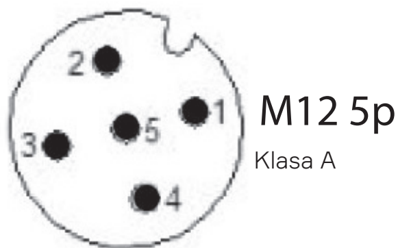
Figure 7 Konfiguracja wtyków w wersji IO-link.
