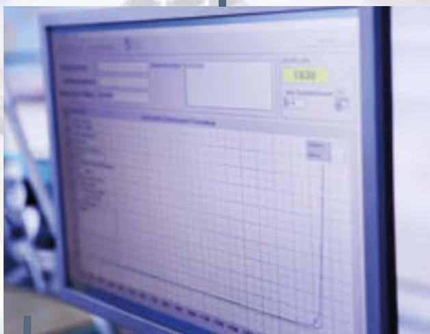
EDV-gestützter Prüfstand für die Einschaltzahl.
