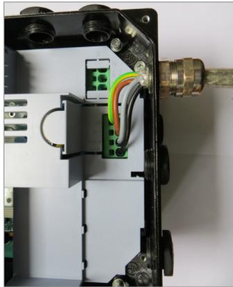
Abbildung 3.3: Details der Verbindung des Motorkabels
