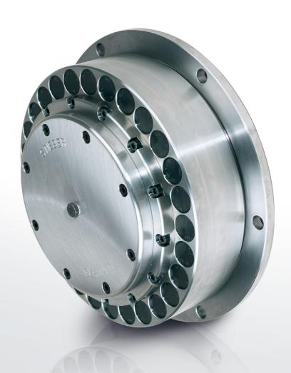
Bei den Bauarten RSRV und RSRT handelt es sich um fliehkraftabhebende RSCI – Klemmkörperfreiläufe (» siehe Seiten 72 bis 75), die zusätzlich mit einer kraftschlüssigen Drehmomentbegrenzung ausgestattet sind. Diese begrenzt das übertragene Drehmoment auf einen Maximalwert, der werkseitig eingestellt wird. Die Verwendung von speziellen, ölgetränkten Reibbelägen gewährleistet eine gleichbleibende Drehmomentgrenze, auch nach langer Stillstandzeit.
