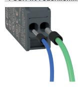
Mit der PUSH-IN Anschlusstechnik kann die Verkabelung schnell und unproblematisch erfolgen, da nur der Draht in die entsprechende Öffnung eingeführt werden muss. Dabei wird die elektrische Verbindung hergestellt und der Draht automatisch arretiert (zum Patent angemeldet).
