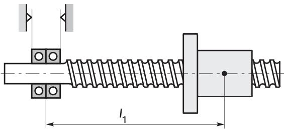
$$R_{s1} = \frac{A \cdot E}{l_1 \cdot 10^3} \quad [\text{N}/\mu\text{m}]$$
