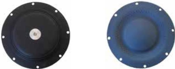
Die TU-Membran hat nur luftseitig einen Stabanschluss und eine leicht zu reinigende Flüssigkeitsoberfläche. Das bedeutet, dass sich hinter Schrauben, Mittelscheiben usw. keine Farb- oder Lackreste ansammeln, was eine Farbverschmutzung verhindert.
