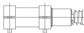
S33 = 2 Flansche + 4 Schrauben M6x40, DIN 912
