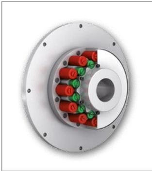
**RINGFEDER® TNR**, die neuartige nicht-schaltbare Kupplung, mit einstellbaren dynamischen Kennwerten bei gleichbleibenden äußeren Abmessungen. Die drehnachgiebige Kupplung ist in allen Richtungen beweglich und gleicht daher Wellenverlagerungen der zu verbindenden Maschinen in winkliger, radialer und axialer Richtung aus.
