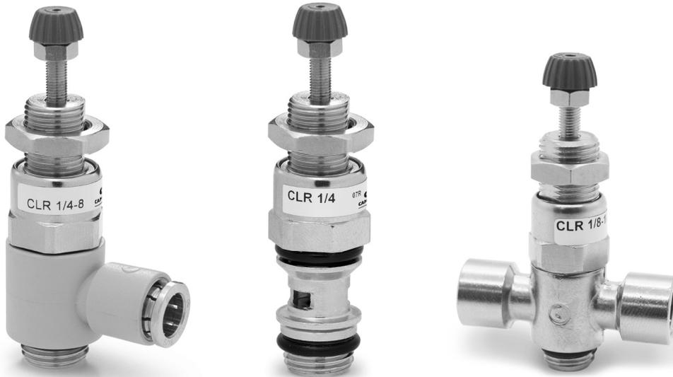
Die Miniaturregler Serie CLR sind mit den Anschlüssen G1/8" und G1/4" verfügbar. Es handelt sich um einen Kolbenregler mit oder ohne Sekundärentlüftung. Die Hohlschraube dieses Reglers besteht aus Messing/vernickelt, der in seiner Lage einstellbare Anschluss/Ringstück aus Kunststoff. Die Regler können ohne oder komplett mit Steckanschluss geliefert werden und ermöglichen auch eine Schalttafelmontage.
