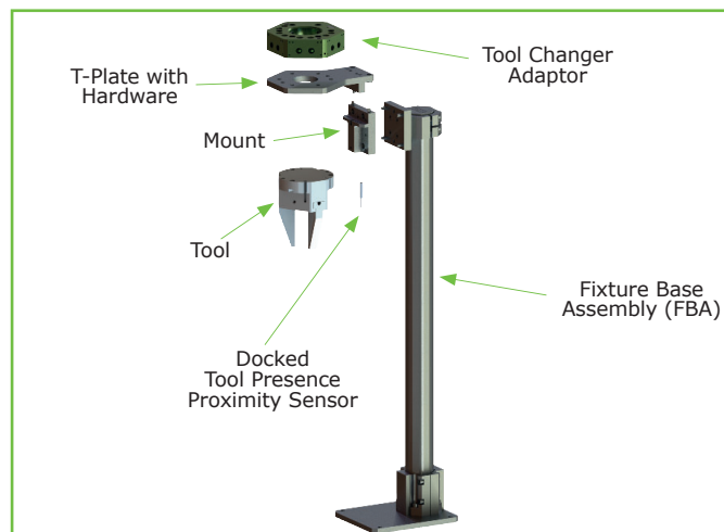
Examples of configuration. • Konfigurationsbeispiele. • Ejemplos de configuración. • Exemples de configuration. • Esempio di configurazione
