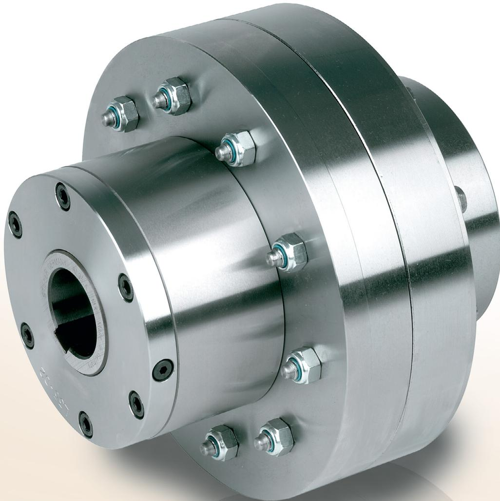
Die Bauart AL..KEED2 ist ein abgedichteter, montagefertiger Rollenfreilauf, gelagert mit zwei Kugellagern der Reihe 160.. Die Lieferung erfolgt mit Ölfüllung.
