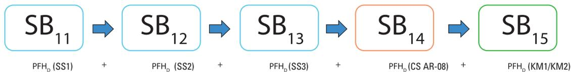
Die Sicherheits-Funktion 2 wird mit 2 Subsystemen realisiert (SB):
