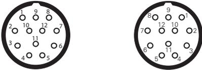
Nummerierung im Uhrzeigersinn    Nummerierung gegen den Uhrzeigersinn
