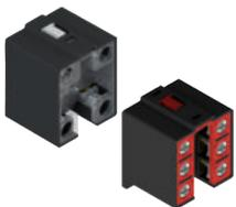
Kontakteinheiten mit unverlierbaren Schrauben und Fingerschutz. Die Kontakte mit doppelter Polbrücke und Doppelunterbrechung sorgen für eine höhere Kontaktzuverlässigkeit. In verschiedenen Ausführungen mit abgestuften Schaltwegen, simultan oder überlappend lieferbar. Sie eignen sich für die unterschiedlichsten Anwendungen.
