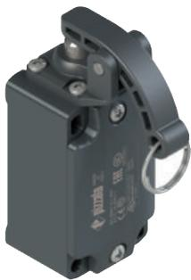
Für die Baureihen FD, FP, FL, FC für raue Anwendungen gibt es den Betätiger 09, der über einen robusten Hebel die Betätigung des Schalters mit einem Seil oder einer Zugstange ermöglicht. Diese Art der Betätigung ist besonders nützlich, wenn das Gerät für bestimmte Anwendungen, wie das Öffnen von Sektional- oder Kipptoren, an der Wand oder Decke installiert werden muss.
