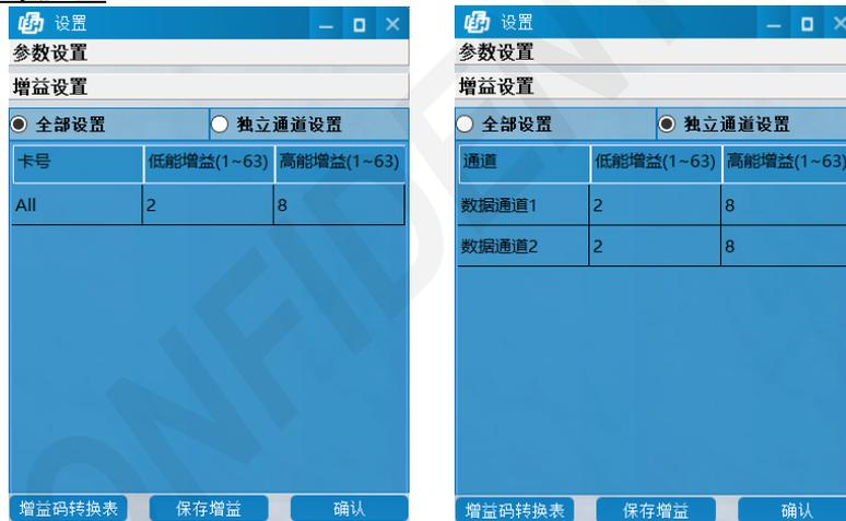
软件支持两种模式设置增益：为所有探测器模块高低能设置相同增益（“全部设置”选项）和单独为不同数据通道探测器的高低能单独设置增益（“独立通道设置”选项），以支持双视角单采集卡应用。
