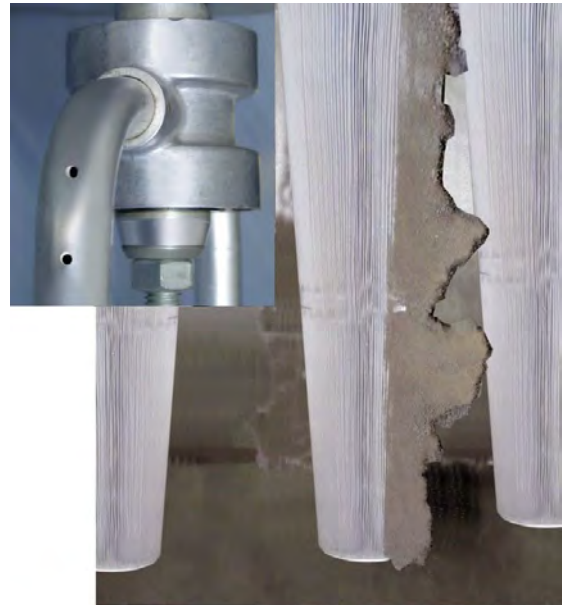
Rotationsluftdüse bei der Abreinigung
