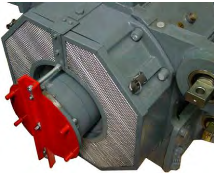
Vorfilter Ansaugluft/Kühlung eines elektrischen Motors
