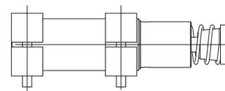
S64 = 2 Flansche + 4 Schrauben M10x80, DIN 912
