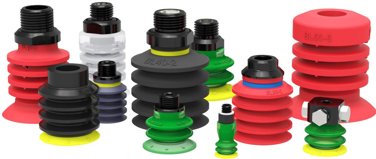
Mehrfachbälge sind geeignet für Höhenunterschiede, leicht gekrümmte Flächen und unebene Oberflächen, Für die Handhabung von Beuteln, Kartons, bei hohen Temperaturen oder gegebenenfalls speziell in Berührung mit Nahrungsmitteln, da sie auch in Materialien erhältlich sind, die FDA-konform sind (FDA 21 CFR 177.2600) und die EU-Richtlinie EU 1935/2004 erfüllen.
