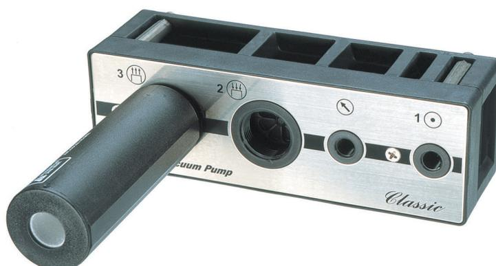
Diese Ejektoren sind Piabs traditionelle Vakuumejektoren, die für die chemische Industrie entwickelt wurden bzw. in chemisch aggressiven Umgebungen eingesetzt werden können. Sie können ein extra tiefes Vakuumniveau von bis zu 100,8 –kPa erreichen. Sie sind mit der Aluminiumanschlussplatte (AD) und der Kunststoffanschlussplatte (D) erhältlich. Wir empfehlen sie, wenn praktisch keine Leckage vorhanden ist sowie bei nicht porösen Anwendungen.
