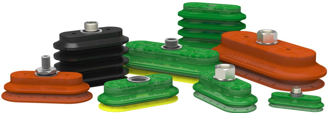
Ovale Saugnäpfe sind besonders für die Handhabung von langen und schmalen Gegenständen und deren Oberflächen geeignet, wenn maximale anhebende Kraft gewünscht wird. Ovale Saugnäpfe mit Balg sind besonders für unregelmäßige Oberflächen geeignet und wenn ein Höhenausgleich gewünscht wird. Die ovalen Saugnäpfe in diesem Produktprogramm besitzen Eigenschaften, die besonders für das Blechhandling geeignet sind.
