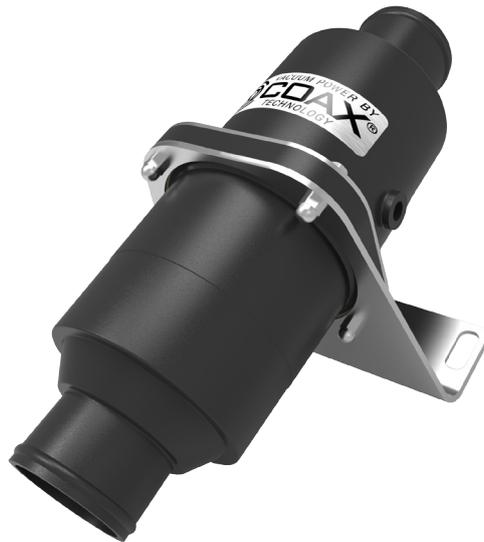
Dieser Ejektor ist mit den energieeffizienten COAX® Cartridges ausgestattet. Er wurde für eine hohe Saugleistung mit 6x COAX® Si MIDI Cartridges entwickelt. Dennoch ist er klein, kompakt und leicht (1,6 kg). Einfache Montage und Installation mit integrierten Schlauchanschlüssen.
