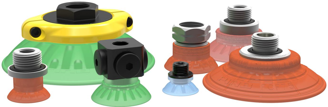
Die flachen konkaven Friction Sauger und Saugnäpfe aus DURAFLEX® erfüllen die strengen Anforderungen der Automobilindustrie und wurden für flache und gewölbte Oberflächen entwickelt. Eine typische Anwendung ist die Zufuhr von Blech in ein Presswerkzeug. Das FCF-P-Design eignet sich für ölige, leicht gewölbte und flache Oberflächen, wie zum Beispiel beim Hantieren mit Blech in Pressenstraßen. Die Saugnäpfe sind mit Stützrippen ausgestattet, die eine Verformung von dünnen Objekten verhindern.
