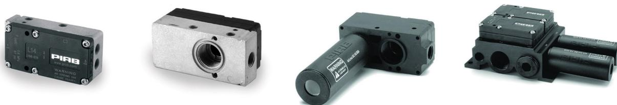
Diese Baureihe, mit den sehr kleinen Abmessungen und geringem Gewicht, ermöglicht ein extra Vakuumniveau von bis zu 84 -kPa. Einige Modelle sind mit einer Anschlussplatte aus Aluminium oder Kunststoff ausgestattet. Diese Ejektoren werden empfohlen, wenn es sich um ein dichtes bzw. nicht poröses Material handelt, wie z.B. Kunststoff, Metall oder Glas.
