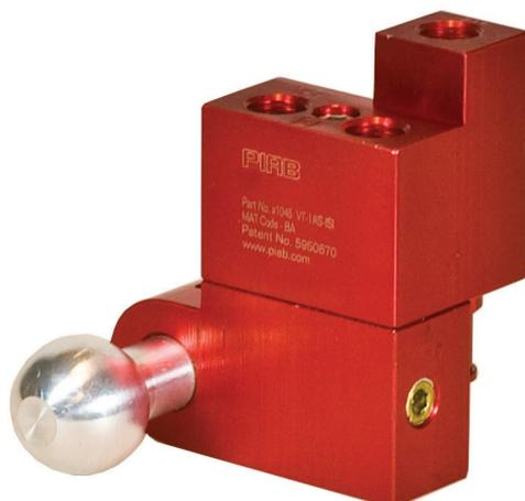
Der Ejektor ist mit einem integrierten zweistufigen COAX® Cartridge MINI Pi12-2 verfügbar sowie mit den Zapfen 16, 19 mm oder einer Kugelanbindung -ball joint-, Industriestandard. Erhältlich mit einem Niveauausgleich zum Höhenausgleich sowie einem Abblasventil zum schnellen Lösen des angesaugten Objektes.
