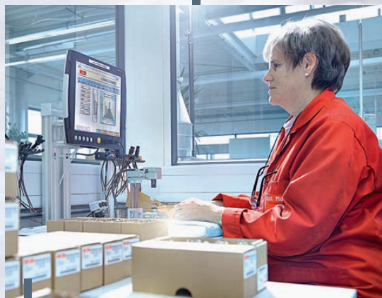
Plně automatické nastavení spínacího bodu s dokumentací naměřených hodnot výpočetní technikou.
