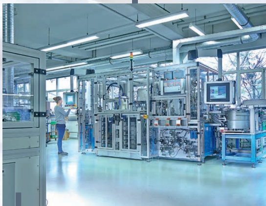
Montáž a zkoušky tlakových spínačů na poloaž automatických a plně automatických linkách.
