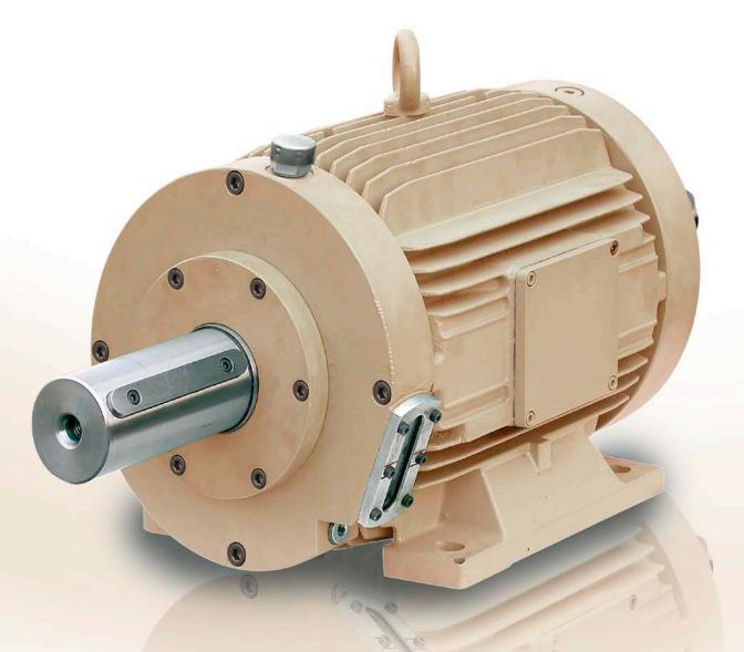
ie Bauart AL..G ist ein gelagerter Klemmrollenfreilauf, der in einem Gehäuse eingebaut ist. Ölschmierung ist vorgeschrieben. Dieser Gehäusefreilauf wird für wechselweise arbeitende Zwei-Motoren-Antriebe eingesetzt (Gebläse, Turbinen, Pumpen). Das Gehäuse mit optimierter Kühlfläche und großem Ölvolumen bietet hohe Sicherheit bei kontinuierlich laufenden Anlagen ohne Überwachung. Die Verbindung zu den antreibenden und den getriebenen Maschinen erfolgt über elastische Kupplungen.
