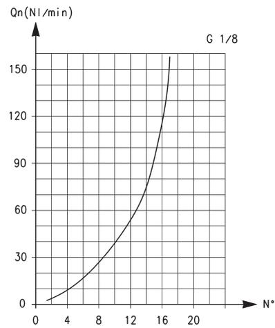
\*QN = Drossel geöffnet + Rückschlagweg = 200 NI/min
