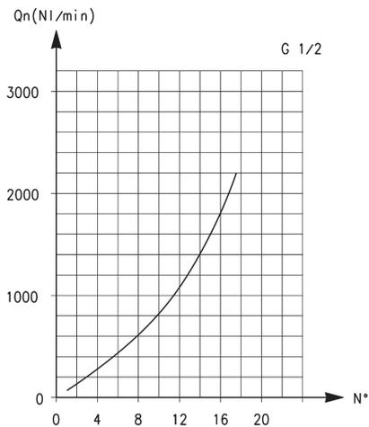
\*Qn Drossel geöffnet + Rückschlagweg = 2570 NL/min.
