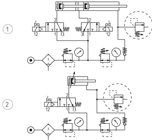
Schaltbeispiel 1: Entlüftung des Überdrucks aus einer Zylinderkammer oder aus einem Behälter, wenn der eingestellte Wert überschritten wird.
