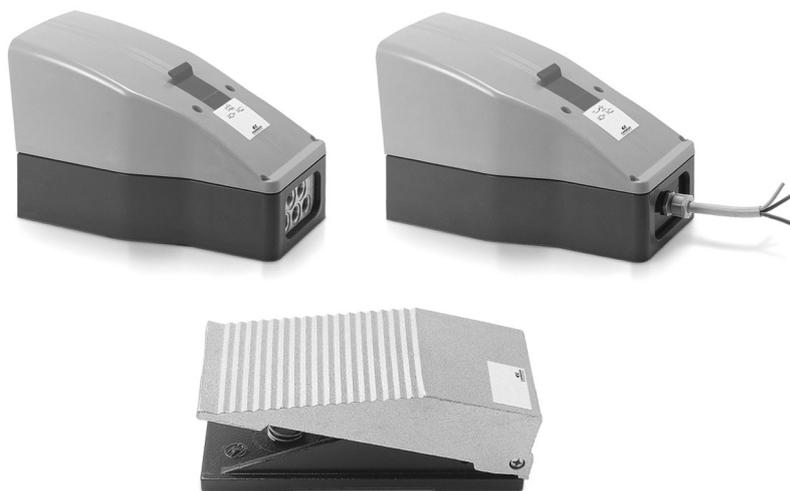
Diese Fußschalter (Serie 3) sind in pneumatischer und elektrischer Version erhältlich. Die pneumatischen Ausführungen sind in 5/2-Wege und 3/2-Wege NC mit den Anschlüssen M5, G1/4" und Steckanschluss  $\varnothing$  4 mm verfügbar. Die pneumatischen Anschlüsse befinden sich stirnseitig am Ventil. Der elektrische Fußschalter enthält einen Mikroschalter, der Anschluss PG9 befindet sich auf der Rückseite.
