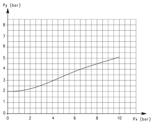
Dieses Diagramm zeigt den Zusammenhang von Betriebsdruck (Px) und Betätigungsdruck des entsperbaren Rückschlagventils (Py). Der Öffnungsdruck beträgt 0,3 bar.
