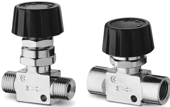
Bei dieser Baureihe handelt es sich um ein handradbetätigtes Drosselventil. Es eignet sich zum Absperren bzw. Drosseln von Druckluft und anderen Medien. Bei den Modellen 2810, 2820, 2819 und 2829 besteht die Möglichkeit, die Kunststoff-, Kupfer- oder Messingrohre direkt mit der Überwurfmutter 1303, dem Klemmring 1310 und der Einsteckhülse 1320 zu verbinden.
