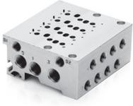
Reihengrundplatten werden in 1 mit Druckluft versorgt und in 3 + 5 entlüftet. Entlüftung der Vorsteuerventile 82 + 84 für alle Ventilpositionen gefasst.
