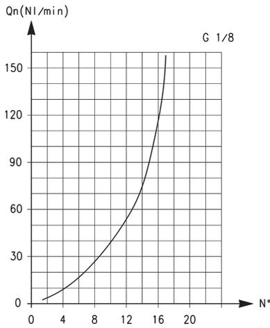
\*Qn Drossel geöffnet + Rückschlagweg = 200 NL/min.
