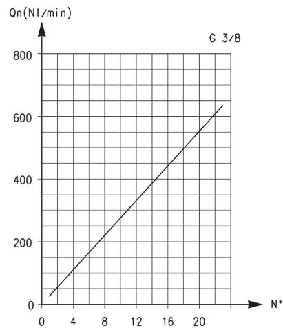
Qn = Drossel geöffnet + Rückschlagweg = 710 NI/min
