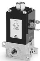
elektrisch betätigt, mit Federrückstellung, Handhilfsbetätigung. Erhältlich mit Druck- und Verbraucheranschluss G1/8" oder Steckanschluss Ø 4 mm. Verbindungsschrauben und O-Ring im Lieferumfang enthalten.
