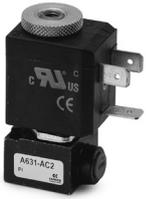
Ideal zur direkten Batteriemontage mit Hilfe von 2 Schrauben. Die Abdichtung erfolgt über 2 O-Ringe, die eine 360°-Drehung ermöglichen. Ausgestattet mit einer bistabilen Handhilfsbetätigung.
