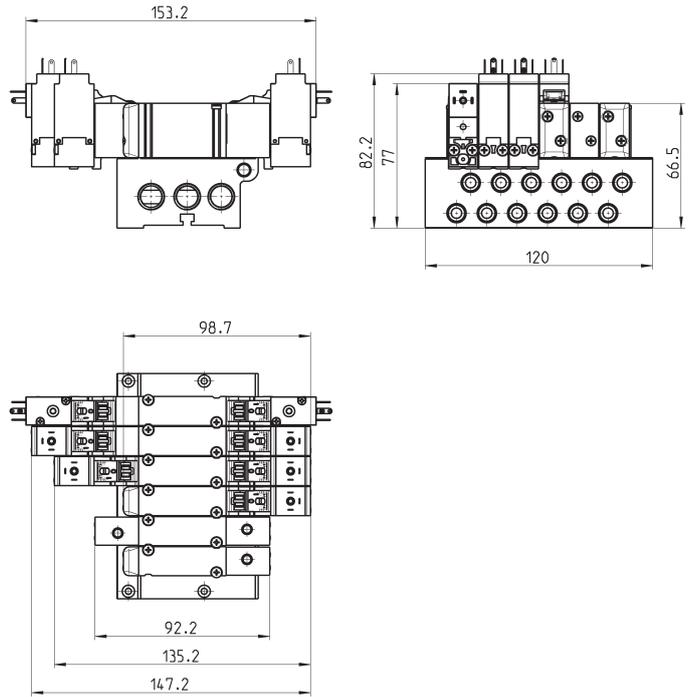
**Maße kompl. Reihengrundplatten, Ventilkörper - Baubreite 19 mm**
