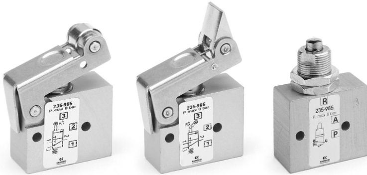
Die Miniventile der Serie 2 mechanisch betätigt sind als 3/2-Wege NC mit Gewindeanschluss M5 oder Steckanschluss Ø 4 mm verfügbar. Die Betätigungsvarianten sind Rollenhebel, Kipprollenhebel oder Stößelventil.
