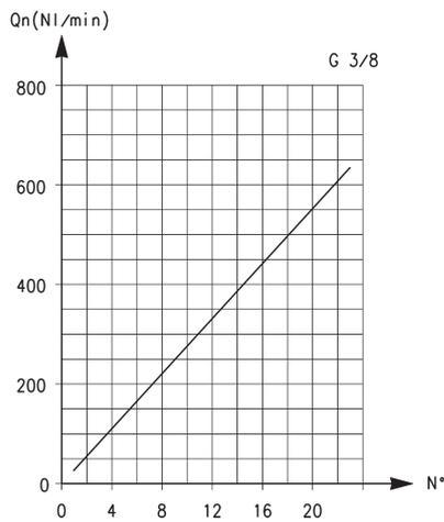
\*Qn Drossel geöffnet + Rückschlagweg = 710 NL/min.
