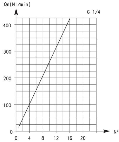
\*Qn Drossel geöffnet + Rückschlagweg = 530 NL/min.
