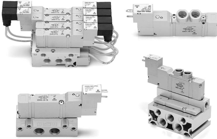
Die Serie E ist für den Einsatz als Einzelventil oder für Batteriemontage vorgesehen. Für diese Ventile ist eine Grundplatte mit gefasster Zuluft P und gefasster Abluft R + S verfügbar. Die Anschlüsse A und B befinden sich an der Oberseite der Ventile.
