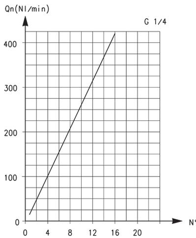
Qn = Drossel geöffnet + Rückschlagweg = 530 NI/min
