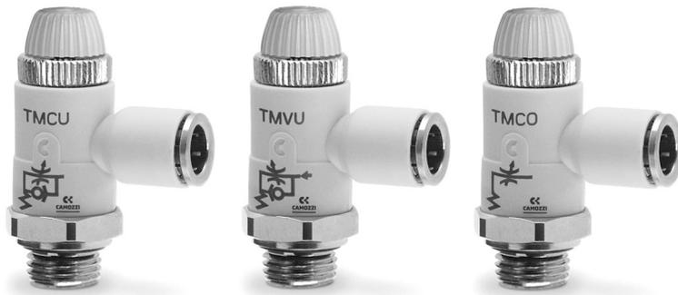
Die Drossel-, Drosselrückschlagventile der Serie TMCU, TMVU und TMCO wurden entwickelt, um eine Lösung anzubieten, die bei reduzierten Bau-massnahmen sehr gute Durchfluss-eigenschaften aufweist. Ihre kompakte Konstruktion erlaubt eine einfache Montage an Zylindern und Ventilen und bietet die Möglichkeit die vorgenommene Durchflusseinstellung über eine Kontermutter zu sichern.
