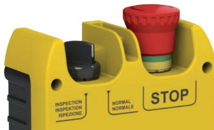
La protection des dispositifs contre les chocs et le piétinement est garantie tant par la structure solide du boîtier fabriqué dans un matériau robuste et aux parois épaisses, que par l'utilisation de boutons-poussoirs encastrés et donc ne dépassant pas de la surface du boîtier d'inspection.
