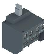
Bloc de contact innovateur à 4 contacts, disponible dans différentes configurations de contacts pour surveiller l'actionneur ou l'électroaimant (breveté). Le bloc est équipé de vis imperdables et de plaques de soulèvement automatique. Protège-doigts amovibles pour cosse à œillet.
