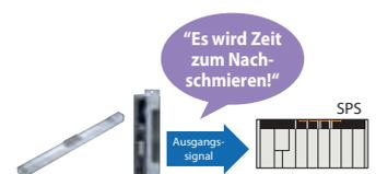
Ein Signal wird automatisch an die SPS ausgegeben, wenn der voreingestellte Wartungs-/Inspektionszeitpunkt (nach Anzahl der Betriebseinsätze oder der zurückgelegten Wegstrecke) erreicht wird.
