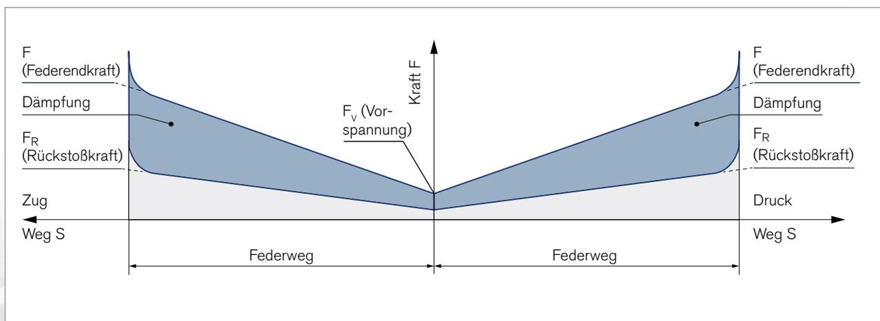
Kraft-Weg-Diagramm einer Zug-Druck-Einrichtung
