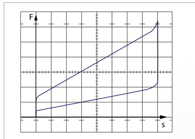
Dynamisches Kraft-Weg-Diagramm einer vorgespannten RINGFEDER® Reibungsfeder
