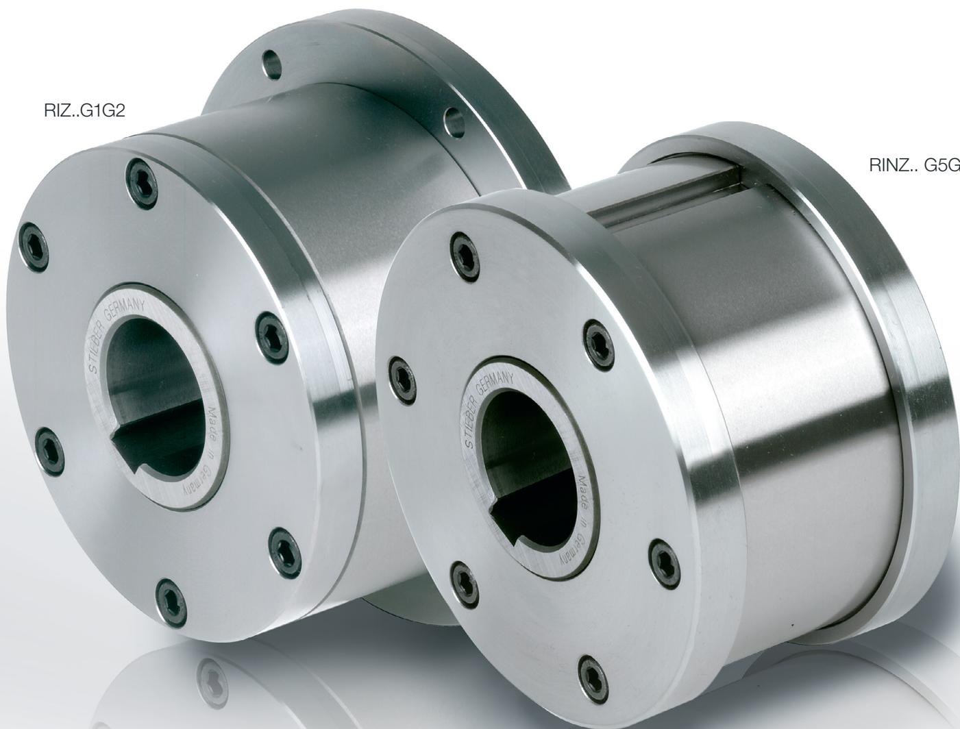
Die Bauarten RIZ..G1G2/G7G2 und RINZ..G5G5 sind fliehkraftabhebende Klemmkörperfreiläufe bei drehendem Innenring. Beim Einsatz als Rücklaufsperrung oder Überholkupplung muss der Innenring die Überholbewegung ausführen.
