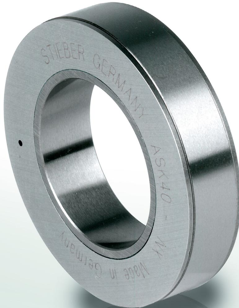
Die Bauart ASK ist ein gelagerter Freilauf mit zwei vollrolligen Lagerreihen. Er ist staubgeschützt und mit einer Fettschmierung versehen.
