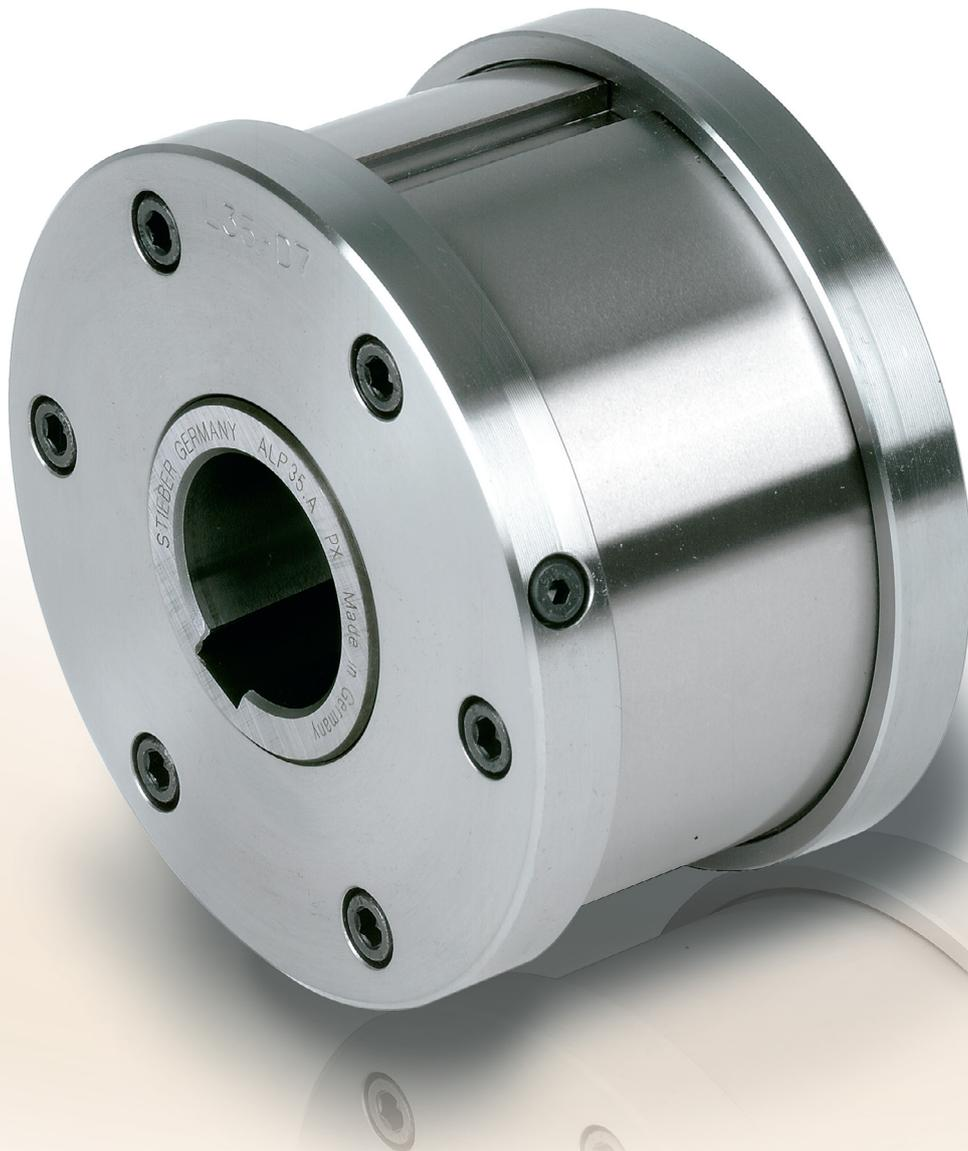
Die Bauart ALP..F7D7 ist ein abgedichteter, montagefertiger Rollenfreilauf, gelagert mit zwei Kugellagern der Reihe 160.. Sie werden ohne Ölfüllung geliefert. Eingesetzt werden diese Freiläufe im Regelfall als Überholkupplung oder Schaltfreilauf (» Beispiel hierzu auf der nächsten Seite). Zur Übertragung des Drehmomentes ist der Außenring mit einer Passfedernut versehen.
