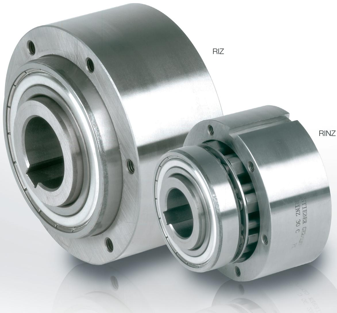
Die Bauarten RIZ und RINZ sind fliehkraftabhebende Klemmkörperfreiläufe bei drehendem Innenring. Beim Einsatz als Rücklaufsperre oder Überholkupplung muss der Innenring die Überholbewegung ausführen. Diese Freiläufe sind mit zwei fettgeschmierten und ZZ-abgedichteten Lagern der Reihe 60.. gelagert.
