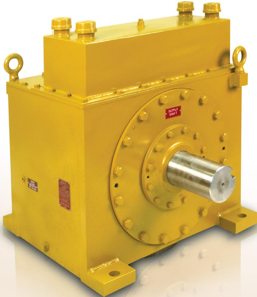
Die Bauart CEUS aus der Produktgruppe CECON ist ein gelagerter Klemmrollenfreilauf, der in einem Gehäuse eingebaut ist. Ölschmierung ist vorgeschrieben. Dieser Gehäusefreilauf wird für wechselweise arbeitende Zwei-Motoren-Antriebe eingesetzt (Gebläse, Turbinen, Pumpen). Das Gehäuse mit optimierter Kühlfläche und großem Ölvolumen bietet hohe Sicherheit bei kontinuierlich laufenden Anlagen ohne Überwachung.
