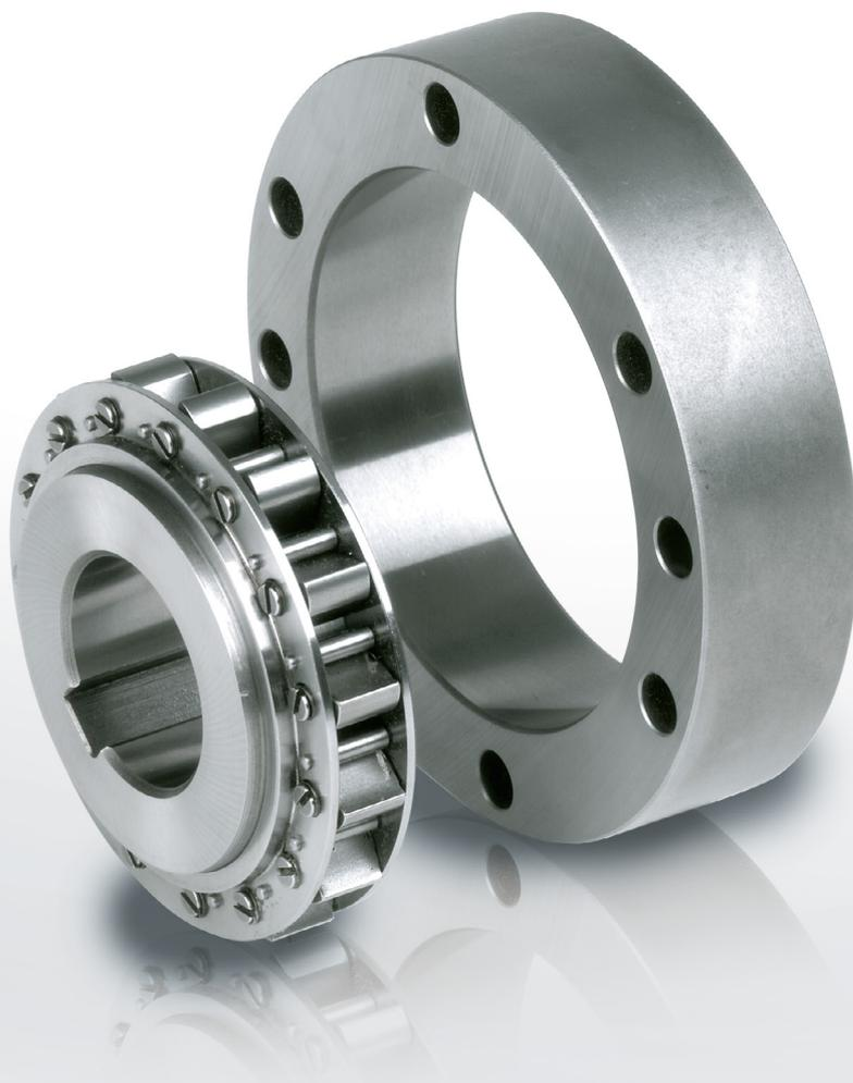
Die Baureihe RSXM rundet das RSCI-Programm bei kleinen Baugrößen ab. Die Bauart RSXM ist ein fliehkraftabhebender Klemmkörperfreilauf bei drehendem Innenring. Nur dieser Ring ist für die Überholbewegung geeignet. Der Freilauf ist ungelagert. Es müssen Lager vorgesehen werden, welche die Konzentrität der Ringe gewährleisten und Radial- und Axialkräfte aufnehmen. Rund- und Planlauffehler müssen innerhalb der angegebenen Toleranzen liegen.
