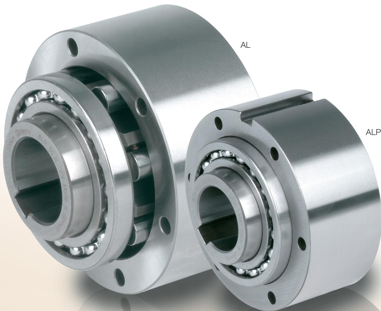
Die Bauarten AL und ALP sind Klemmrollenfreiläufe. Es sind gelagerte Grundeinheiten mit zwei Kugellagern der Reihe 160.. Standardmäßig muss eine Ölschmierung vorgesehen werden. Vorzugsweise werden diese Freiläufe im Gehäuse eingebaut, wo bereits Schmierung und Abdichtung vorhanden sind.
