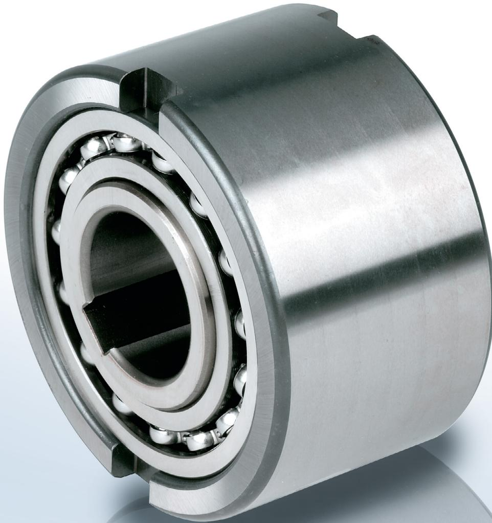
Die Bauart NFR ist ein gelagerter Klemmrollenfreilauf ohne Abdichtung. Abdichtung und Schmierung sind vorzusehen; empfohlen wird Ölschmierung.
