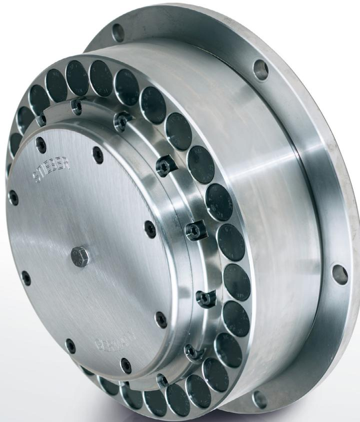
Bei den Bauarten RSRV und RSRT handelt es sich um fliehkraftabhebende RSCI – Klemmkörperfreiläufe (» siehe Seiten 72 bis 75), die zusätzlich mit einer kraftschlüssigen Drehmomentbegrenzung ausgestattet sind. Diese begrenzt das übertragene Drehmoment auf einen Maximalwert, der werkseitig eingestellt wird. Die Verwendung von speziellen, ölgetränkten Reibbelägen gewährleistet eine gleichbleibende Drehmomentgrenze, auch nach langer Stillstandzeit.
