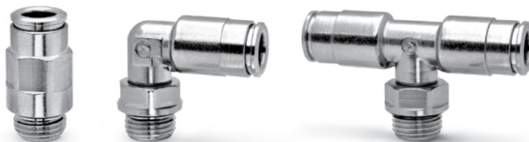
Diese Serie zeichnet sich durch ein doppeltes Dichtsystem aus. Sie beruht auf der am Markt bewährten Serie 6000. Das Hauptmerkmal der Serie 8000 ist die Integration von zusätzlichen Dichtungen (Patent angemeldet), dadurch wird Leckagefreiheit und leichte Verbindung erreicht, sowie eine mögliche Leckage bei Axialbewegungen des Rohres vermieden.
