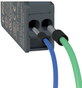
Mit der PUSH-IN Anschluss-technik kann die Verkabelung schnell und unproblematisch erfolgen, da nur der Draht in die entsprechende Öffnung eingeführt werden muss. Dabei wird die elektrische Verbindung hergestellt und der Draht automatisch arretiert (zum Patent angemeldet).
