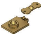
Die Kontakteinheiten können mit elektrischen Silberkontakten mit einer Goldbeschichtung von einem µm geliefert werden. Die Goldbeschichtung ist von Vorteil beim Einsatz in aggressiven Umgebungen, die das Silber angreifen können, sowie bei sehr kleinen elektrischen Lasten mit geringen Versorgungsspannungen und -strömen.
