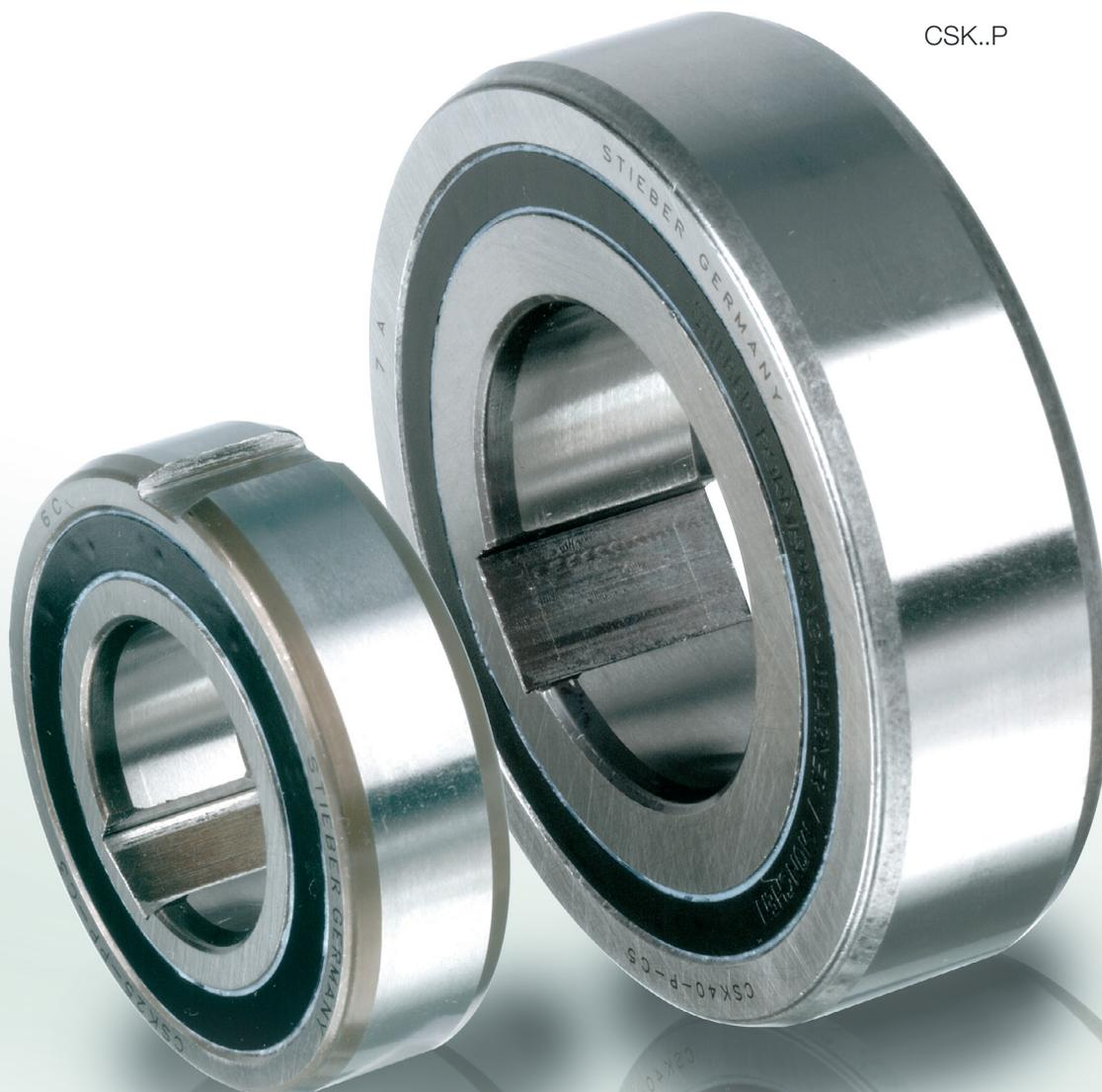
Les modèles CSK..P et CSK..PP sont des roues libres à cames, intégrées dans un roulement de la série 62.. (sauf taille 40). Ce sont des modèles autocentrés, livrés lubrifiés à la graisse et protégé contre les poussières de plus de 0,3 mm.
