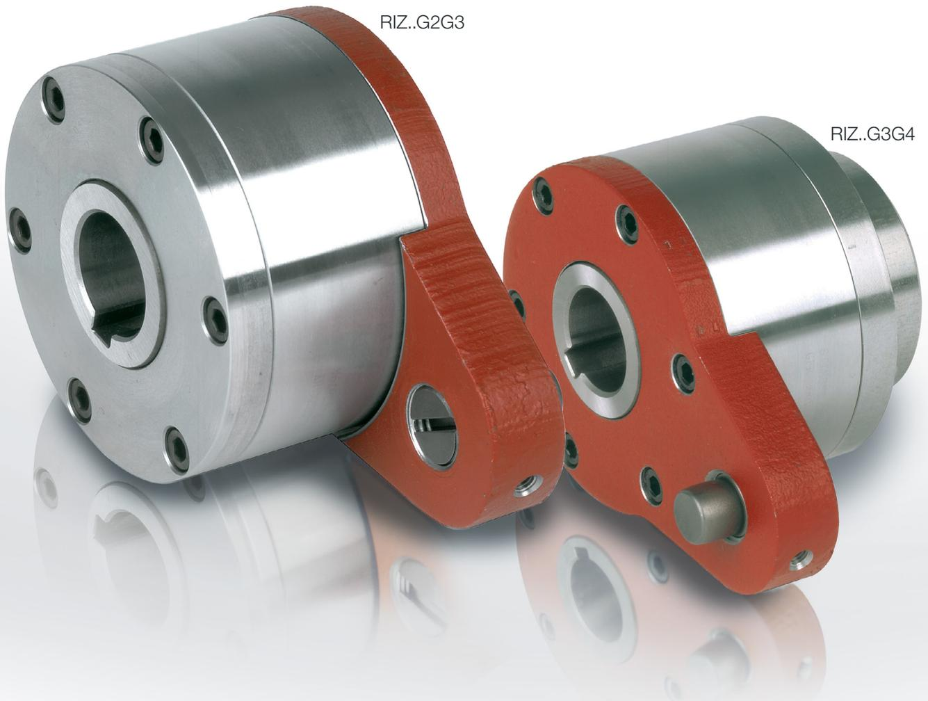
Les modèles RIZ..G2G3/G3G4 sont des roues libres à cames à dégagement centrifuge par rotation de la bague intérieure qui seule est prévue pour tourner en roue libre. Ce sont des ensembles autonomes conçus pour des applications d'antidévireur. La vitesse de rotation en roue libre ne doit pas descendre en dessous de la vitesse minimum donnée dans le tableau de caractéristiques. Prendre garde aux entraînements à vitesse variable. L'axe de réaction doit être logé dans une lumière pratiquée
