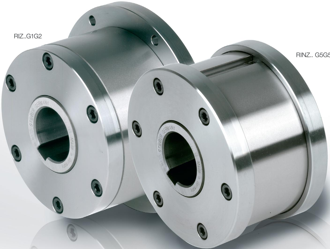
Les modèles RIZ..G1G2/G7G2, RINZ..G5G5 sont des roues libres à cames à dégagement centrifuge par rotation de la bague intérieure qui seule est prévue pour tourner en roue libre.
