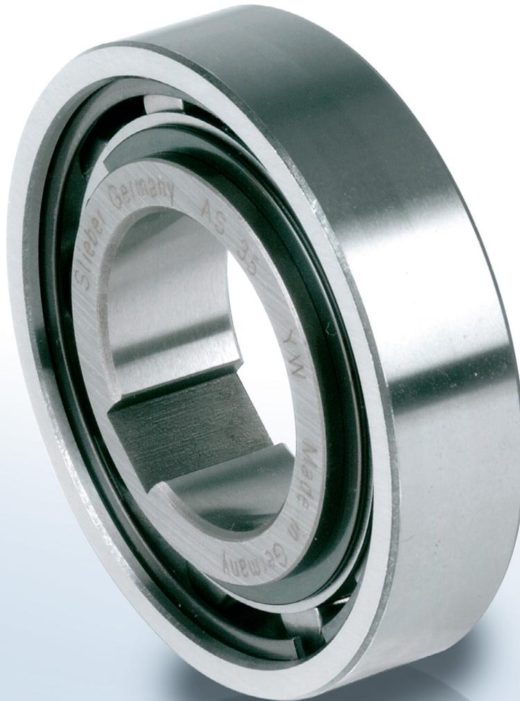
Le modèle AS est une roue libre à rouleaux non autocentrée. Il est nécessaire de l'intégrer dans un montage fournissant roulements, lubrification et étanchéités.
