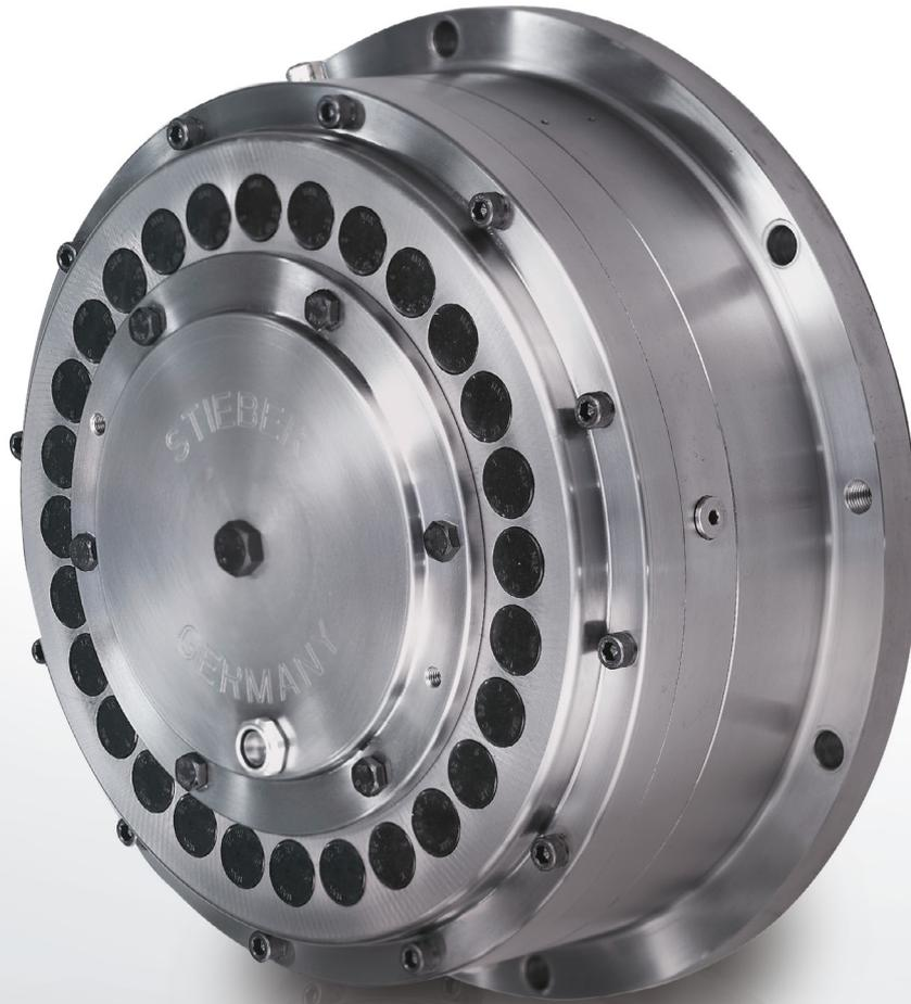
Le modèle RDBK est un antidéviateur hautes vitesses à dégagement centrifuge des cames et équipé en outre d'un système de limitation du couple de retour. Voir le modèle RSCI pages 72 à 75 pour complément d'informations sur cette technologie.
