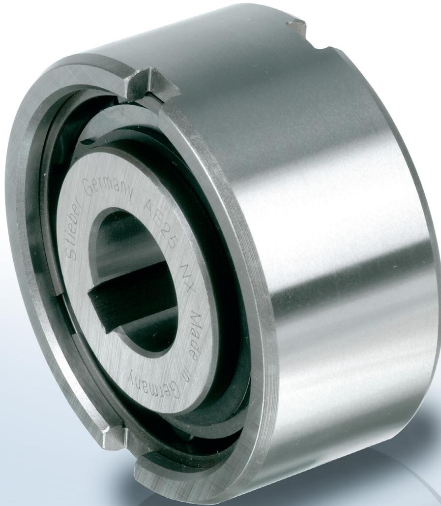
Le dèle AE est une roue libre à rouleaux non autocentrée. Il est nécessaire de l'intégrer dans un montage fournissant roulements, lubrification et étanchéités.
