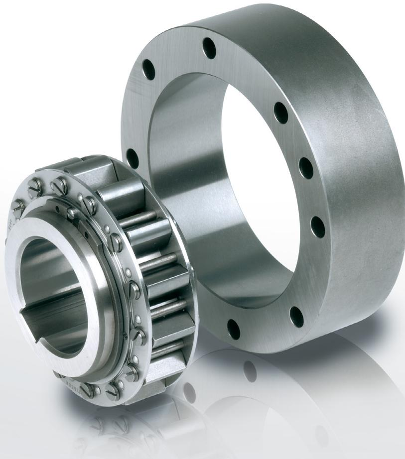
Le modèle RSCI est une roue libre à dégagement centrifuge des cames par rotation de la bague intérieure, qui seule est prévue pour tourner en roue libre. C'est une version non autocentrée.
