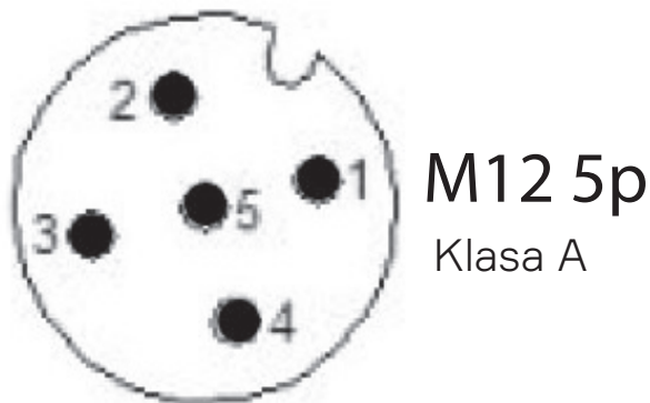
Figure 7 Konfiguracja wtyków w wersji IO-link.
