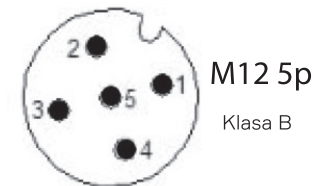
Figure 8 Konfiguracja wtyków z odrębnymi domenami zasilania.
