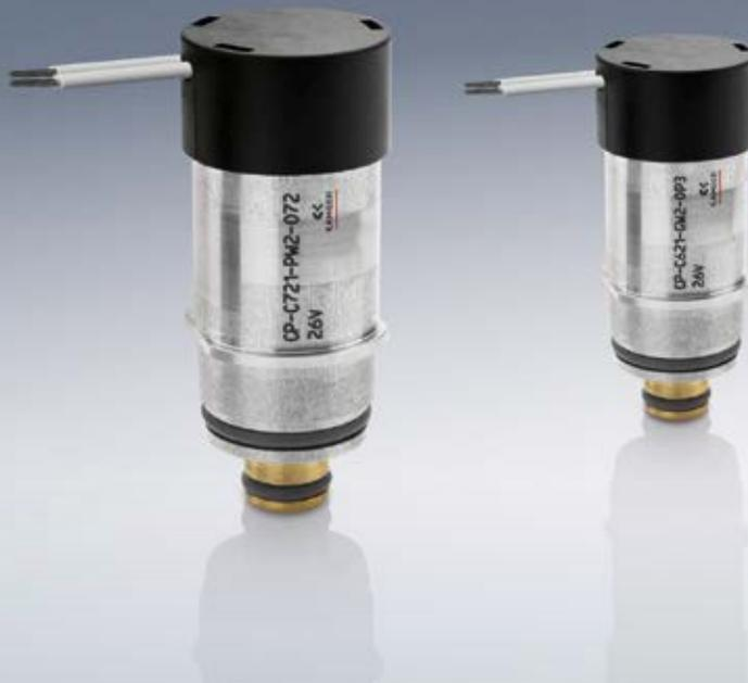
Die direktgesteuerten Proportionalventile Serie CP eignen sich zur Durchflussregelung im offenen Regelkreis, beispielsweise beim Mischen von Gasen oder zur Steuerung von Volumenströmen. Durch die sehr kompakte Patronenbauweise können sie sehr nahe am Einsatzort montiert werden.
