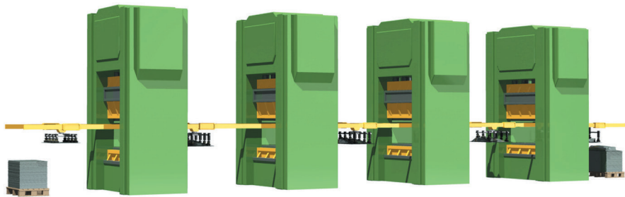
Übertragung von Presse zu Presse
