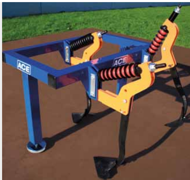
TUBUS Spring sorgen u. a. in Grubberscharen für sicheren, störungsfreien Betrieb
