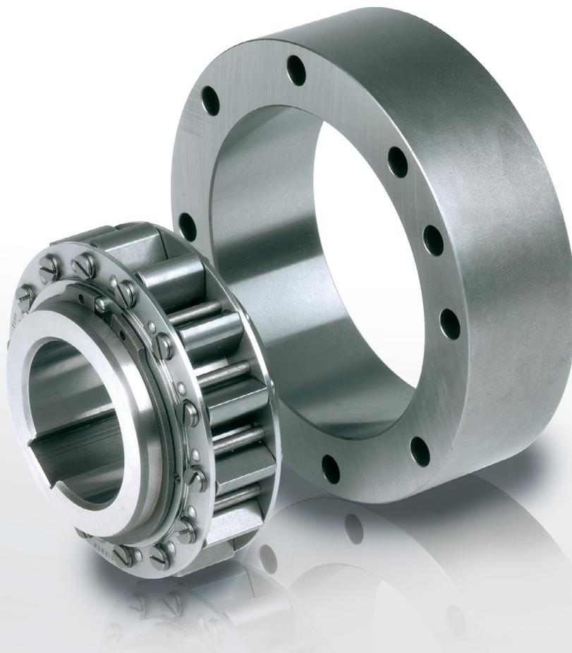
Die Bauart RSCI ist ein fliehkraftabhebender Klemmkörperfreilauf bei drehendem Innenring. Nur dieser Ring ist für die Überholbewegung geeignet. Der Freilauf ist unge- lagert. Es müssen Lager vorgesehen werden, welche die Konzentrität der Ringe gewährleisten und Radial- und Axialkräfte aufnehmen. Rund- und Planlauffehler müssen innerhalb der angegebenen Toleranzen liegen.
