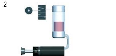
Eingefahren keine Rückstellkraft. Rückstellzeitpunkt über Ventil steuerbar. Ohne Netzdruck keine Funktion.
