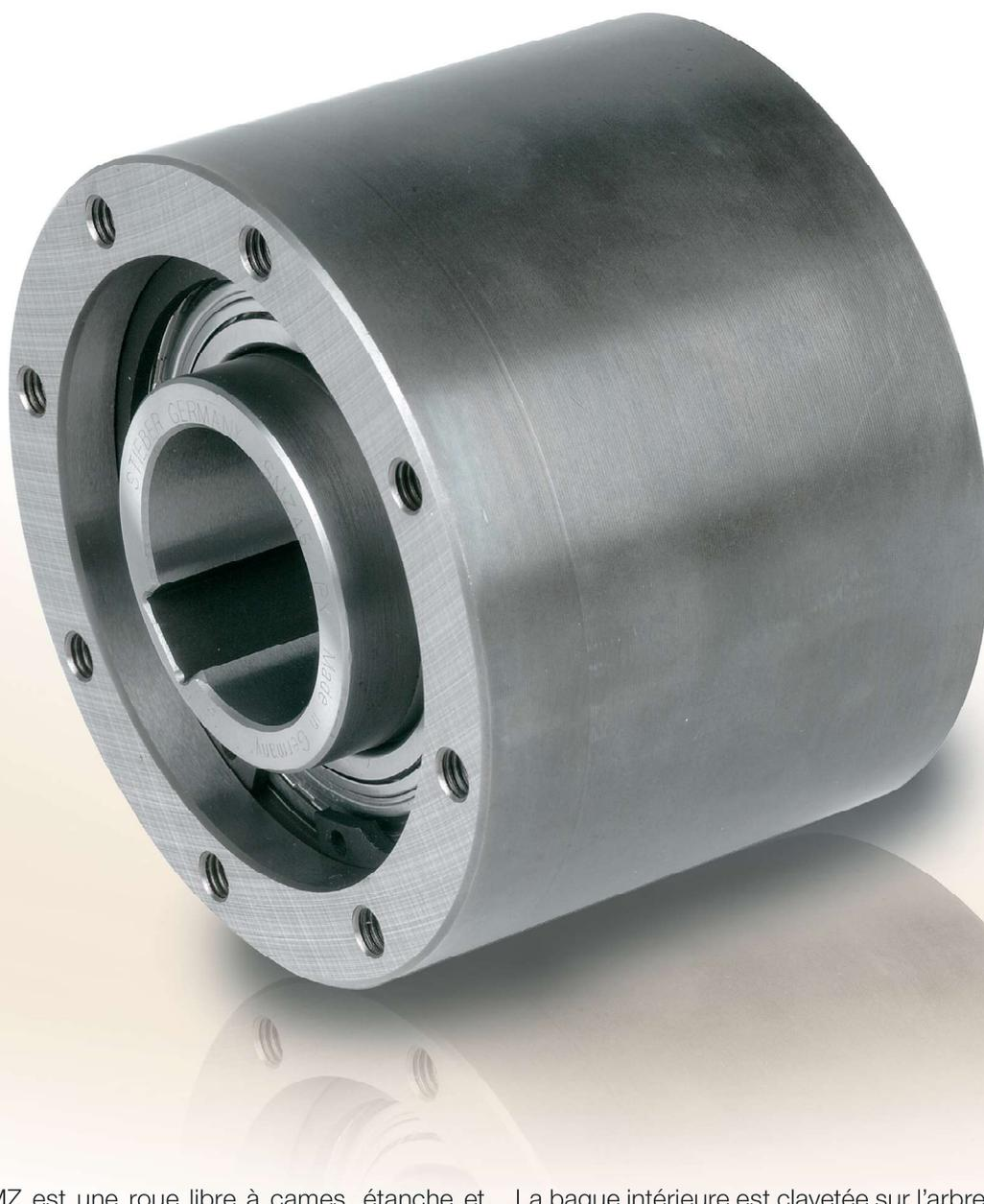
Le modèle SMZ est une roue libre à cames, étanche et autonome, centrée par deux roulements protégés de la série 60..ZZ.
