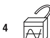
geschützt gegen Eindringen von festen Fremdkörpern  $\geq 1,0$  mm Durchmesser (z.B. Draht)
