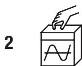
geschützt gegen Eindringen von festen Fremdkörpern  $\geq 12,5$  mm Durchmesser (z.B. Finger)
