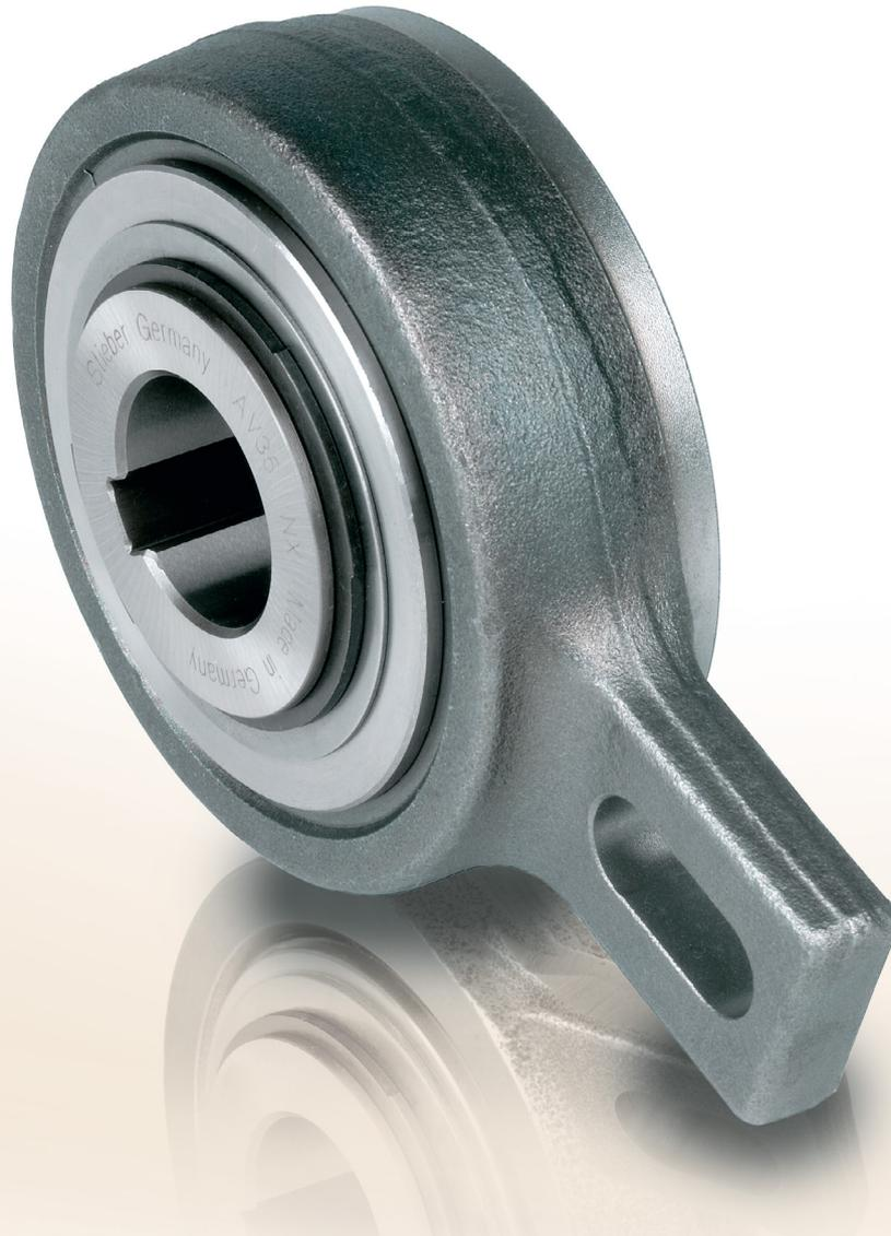
Die Bauart AV ist ein Klemmrollenfreilauf. Er ist gleitgelagert und für niedrige Drehzahlen geeignet. Das Drehmoment ist bei geringem Bauraum sehr hoch. Der Freilauf wird mit Fettschmierung geliefert; die Abdichtung erfolgt mit Labyrinthringen. Er wird montagefertig geliefert für den Einbau in horizontaler oder vertikaler Lage. Diese Bauart wird vornehmlich als Rücklaufsperre eingesetzt. Sie ist besonders geeignet für die Verwendung unter schwierigen Umgebungseinflüssen (Staub, grober Schmutz).
