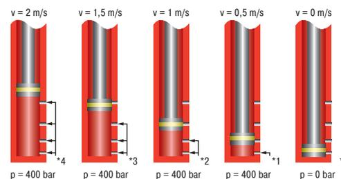
\* Die Anzahl der wirksamen Drosselstellen vor dem Kolben nimmt ab, die Geschwindigkeit wird über den Bremsweg kontinuierlich reduziert. Der Innendruck bleibt nahezu konstant und damit die Kraft-Weg-Kurve nahezu linear.
