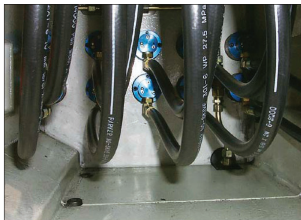
Bezložiskové přívody Deublin 1117 na automobilovém přenosovém potrubí.
