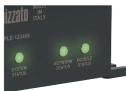
La passerelle de connexion P-Connect est équipée de 3 LED de signalisation intégrées pour permettre à l'utilisateur d'effectuer un diagnostic rapide sur site :
